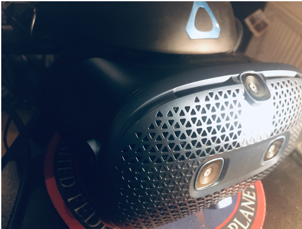
Abbildung 3.14: Die Vive Cosmos von HTC, die ohne externes Tracking funktioniert.
