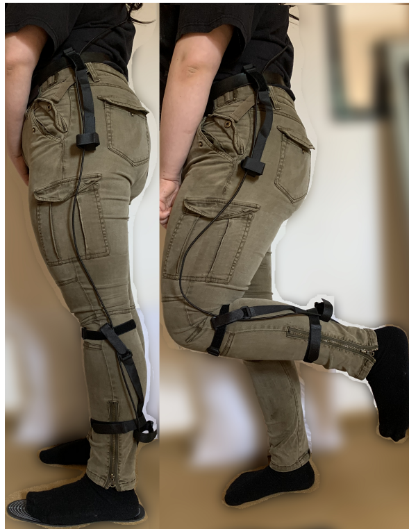
Abbildung 3.5: Die Realisierung der Kabelführung.
