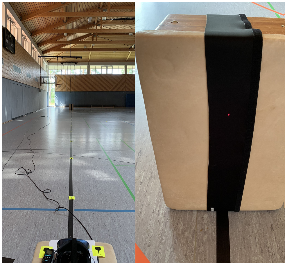
Abbildung 4.1: Das Setup bei der Kalibrierung (im linken Part) und der Laserpunkt beim Ausrichten der Cosmos (im rechten Part).
