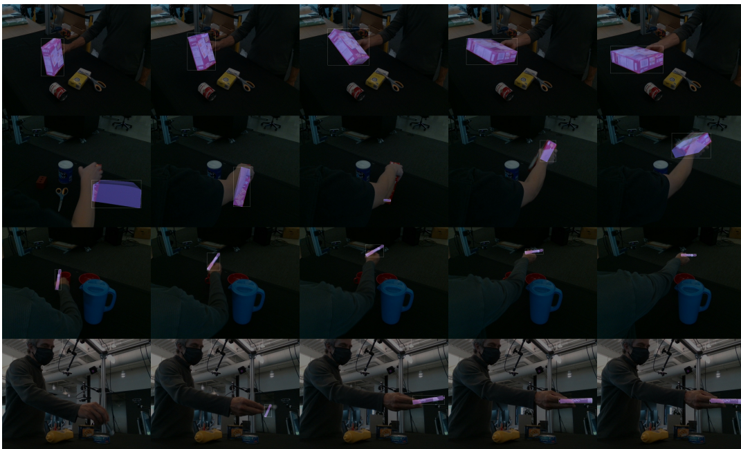
ABBILDUNG A.3: Gute und schlechte geschätzte Posen visualisiert. Bilder aus dem DexYCB Datensatz [20]
