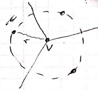
Ann.:  $\Delta pqr \in F_{D(S)} \Rightarrow R(p), R(q), R(r)$  sind paarweise benachbart  $\Rightarrow$  ex Voronoi-Knoten  $v$  mit  $d(v, p) = \dots = r$  und  $C_r(v)$  enthält keinen weiteren Pkt aus  $S$  [expanding circles] (wäre  $s \in S$  im Inneren von  $C_r(v)$ , dann wäre  $s \in R(s)$  und  $p, q, r \notin C_r(v) \Rightarrow W!$ )
