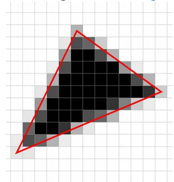
Schätze für jedes Pixel den prozentualen Anteil, zu dem es vom Dreieck überdeckt wird (z.B. durch Super-Sampling)
