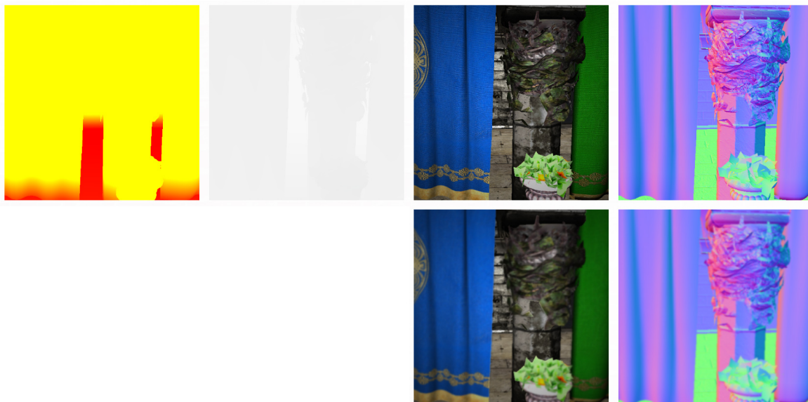
Abbildung 1: Oben: World-Position-, Depth-, Reflected-Flux- und Normal-Buffer der RSM. Unten: Eine leichte Weichzeichnung des Reflected-Flux- bzw. Normal-Buffers sorgt für eine sichtbare Verbesserung der temporalen Kohärenz der GI-Simulation.
