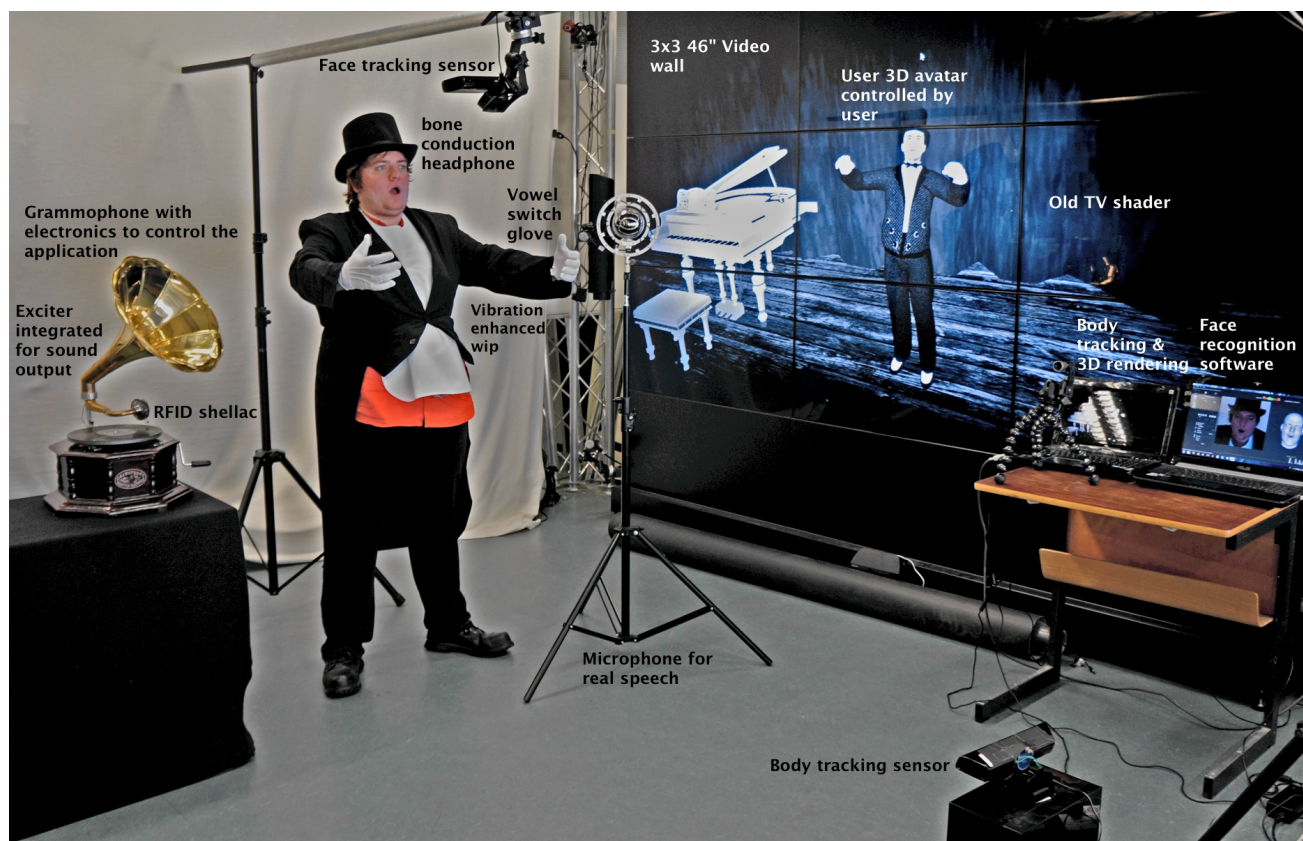
Abbildung 1: Aufbau des Systems
